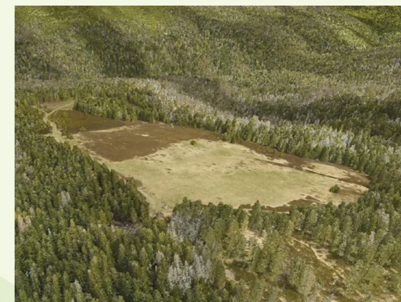
Ryc. 4. Polana Jaworzyna Kamienicka – sklasyfikowana i pokolorowana chmura punktów LIDAR
